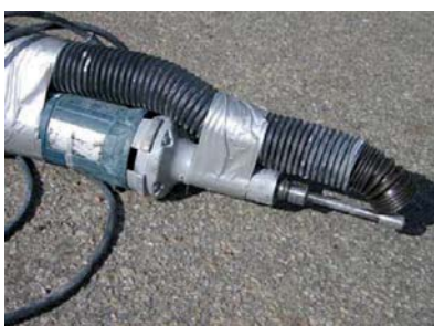
Slipmaskin med kåpa av metall för dammuppsamling
