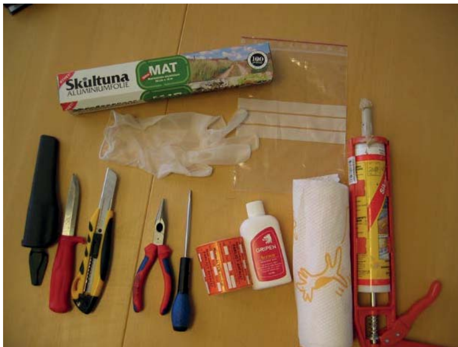
Exempel på utrustning för provtagning av fogmassor
