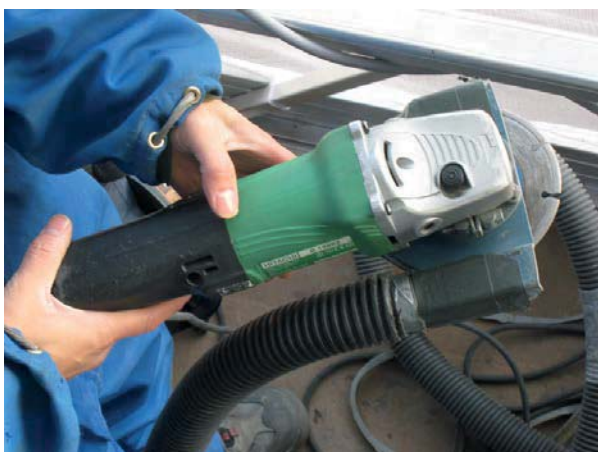
Slipmaskin med kåpa av metall för dammuppsamling
