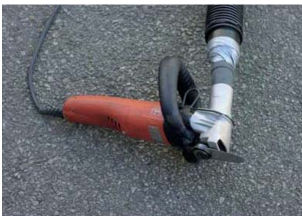
Exempel på verktyg för att skära ut fogmassa.
