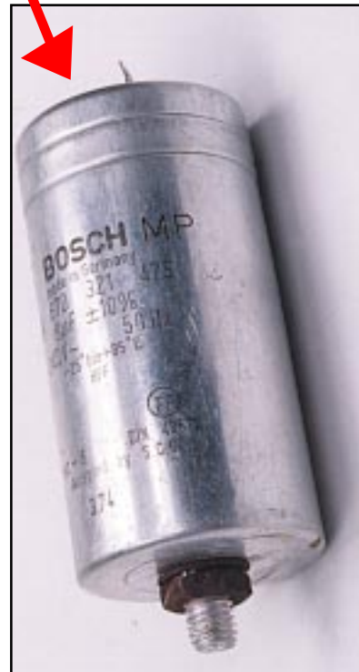
Kondensator typ MP (Metall Papier) med isolering av oljeimpregnerat papper.
